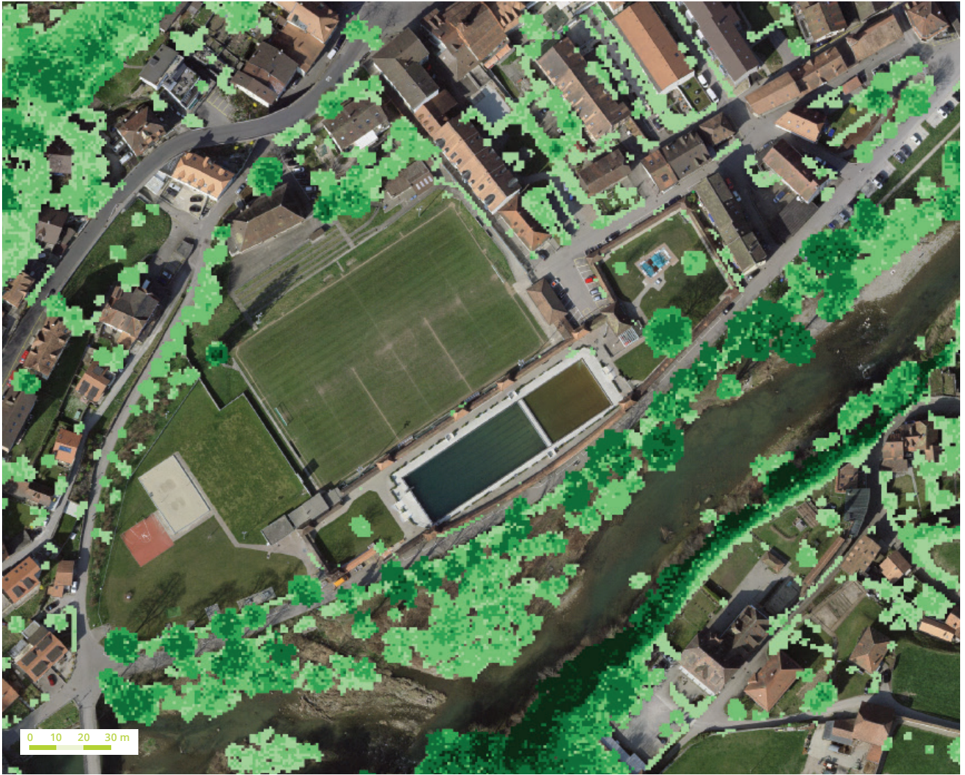
Travail de détection de la canopée à partir de données LiDAR (campagne 2019)
