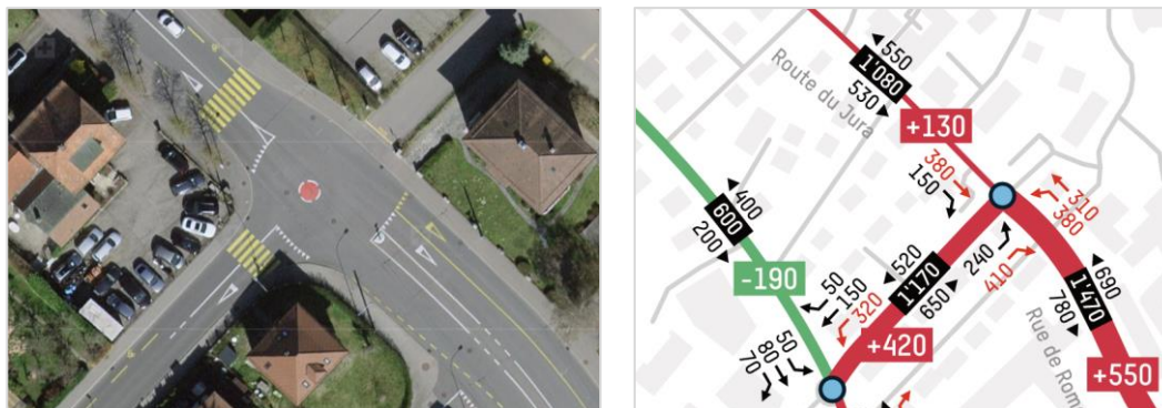
Figure 32 : Situation du giratoire Jura-Montenach et plan de charges HPS variante 2 horizon 2030
