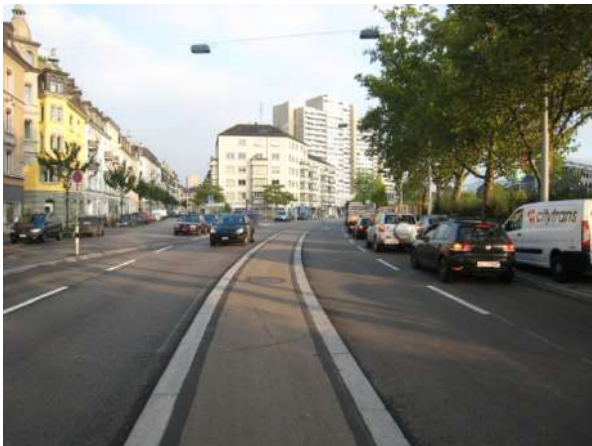
Séparation aménagée sur une route structurante à fort trafic, pour réduire le gabarit de circulation, Seebahnstrasse, Zurich
