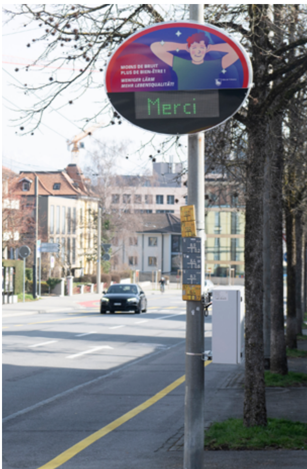
Radar pédagogique indiquant «Merci» lorsque la vitesse est respectée
